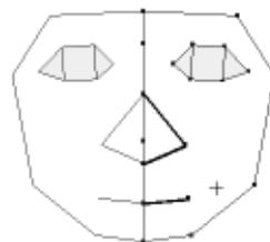
⑰角度ウインドウで視点をぐるぐる動かして形状を確認してください。今入力した鼻と口の線は、横顔の輪郭の頂点とつなげて入力したので、輪郭の頂点と同じ奥行きに生成されています。
