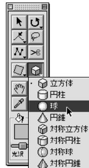
④メインウィンドウ上で option キーを押しながらドラッグして球を作成します。
