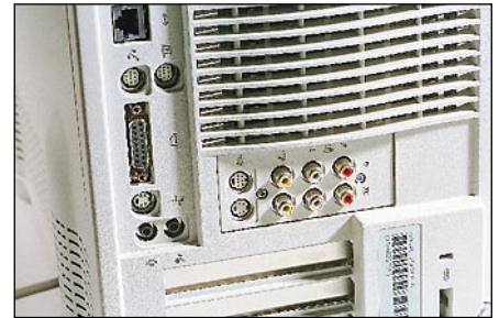
Power Macintosh 8500 ja 7500 takaseinästä löytyy videonauhurin veroinen liitäntäarsenaali. Aiempien AV-mallien kaltaisia sovitimia ei enää tarvita, vaan johdoille löytyy paikka suoraan keskuyksiköistä.
