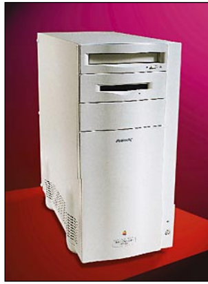
9500-mallien kotelo on seitsemän senttiä 8500-koteloä korkeampi. Muuten kotelo on entisen tornikotelon mallinen, paitsi että oikeassa alakulmassa on vain reset-kytkin.
