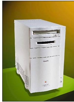
9500-mallien kotelo on seitsemän senttiä 8500-koteloä korkeampi. Muuten kotelo on entisen tornikotelon mallinen, paitsi että oikeassa alakulmassa on vain reset-kytkin.
