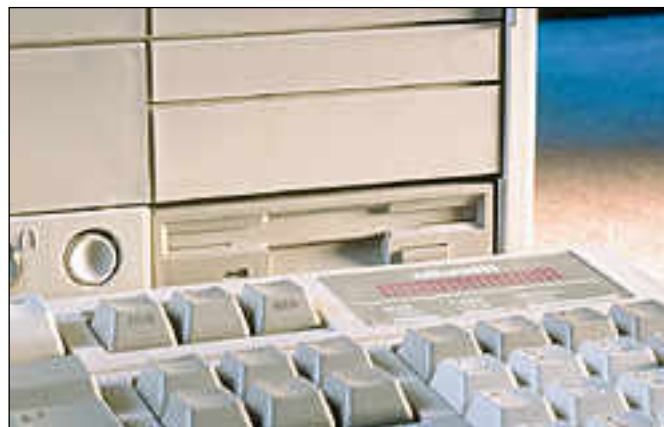
Olivettin pöytäkotelon levykeasema on liian alhaalla. Jos näppäimistö on koneen edessä, levykeasemaa ei voi käyttää.
