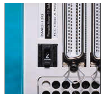
SCSI-laitenumeron valinta on helppoa, jos asemassa on napulat sitä varten. Vain Pinnaclessa oli tällainen.
