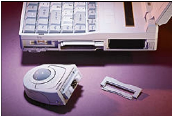
Toshiban oikeassa reunassa on liitin QuickPort-hiirelle ja paikat kahdelle PCMCIA-kortille, joista toinen voi olla tyyppiä III.
