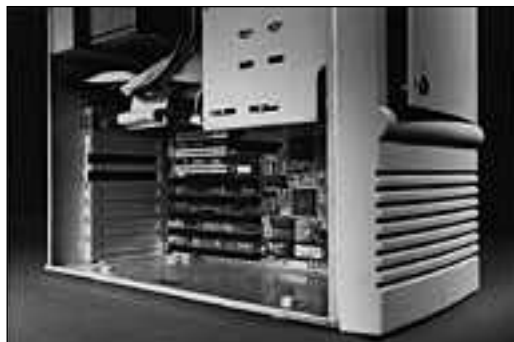
MSI:n emolevyllä on viisi ISA- ja neljä PCI-liitintä. Keskeimmän korttipaikka toimii joko ISA- tai PCI-korttipaikkana.
