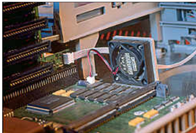
Olivetin Modulo-mallin kotelon pohjalla on pieni tuuletin, joka jäädyttää emolevyllä olevaa prosessoria.
