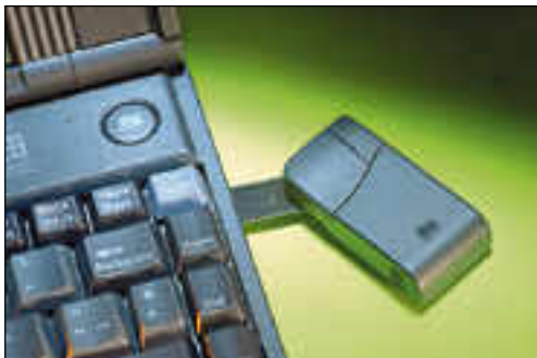
Omnibookin laitteen oikeasta reunasta ponnahtava hiiri on toimiva ratkaisu – mutta vain oikeakätisille.
