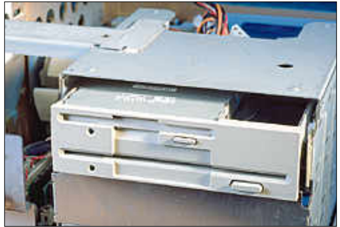
Isot 5,25-tuuman levykkeet ovat jo lähes hävinneet käytöstä. Dellin esittelykoneissa on näppärä tilaa säästävä yhdistelmäasema.
