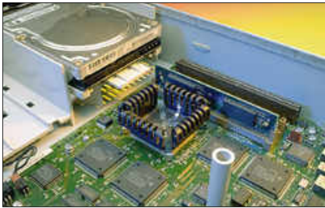
PowerPC 601 on Intelin Pentiumin kanssa jokseenkin samantehoinen, mutta pienemmän tehontarpeen vuoksi jäähdytykseen riittää melko pienet rivit. Testin aikana prosessori pysyi käsinkosketeltavan viileänä.
