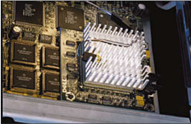
Dellin 90 MHz:n Pentium-prosessori on asennettu välikantaan, joka mahdollistaa 3,3 voltin prosessorin asentamisen 5,5 voltille suunnitellulle emolevyille. Jäähdytys-elementin päällä näkyy lämpötila-anturi.
