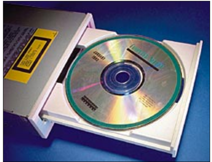
CD-asema, johon levy työnnetään kelkassa, on asennettava vaakatasoon.
