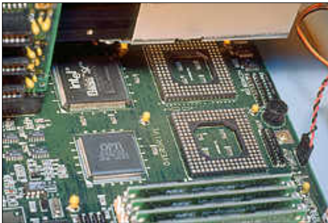
Siemens-Nixdorfissa on peräti kolme prosessoripaikkaa, mutta yhteenkään niistä ei sovi Pentium Overdrive -päivitysprosessori.
