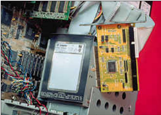
Testin nopein kiintolevykäsitely on ARC:ssä. Ohjaimena siinä on nopea PCI-IDE-kortti, joka tukee neljää IDE-laitetta. Kiintolevy on Seagaten ST5660A.
