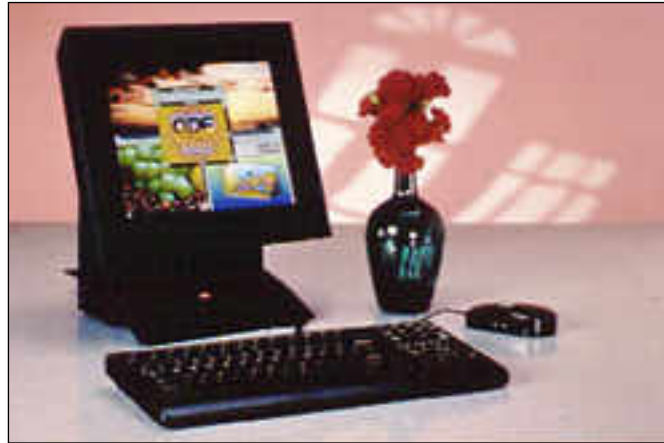
APF:n tyylikkäässä 486/66-mikrossa on 11,8 tuuman TFT-värinäyttö, joka ylittää 1024 x 768 tarkkuuteen. Laitteessa on vakiona PCMCIA II -korttipaikka.
