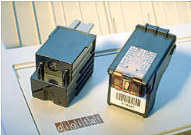
Olivetin koneistolla toimivat kirjoittimet käyttävät mustepatruunaa, jossa kirjoituspää vaihdetaan vain joka seitsemännen mustesäiliön vaihdon yhteydessä. Näin säästetään hieman tulostuskustannuksissa. Kuvassa vasemmalla mustesäiliö, oikealla kirjoituspää-moduli. Mustesäiliö työnnetään kirjoituspää-modulin sisään, jonka jälkeä yhdistelmä asennetaan kirjoittimeen.
