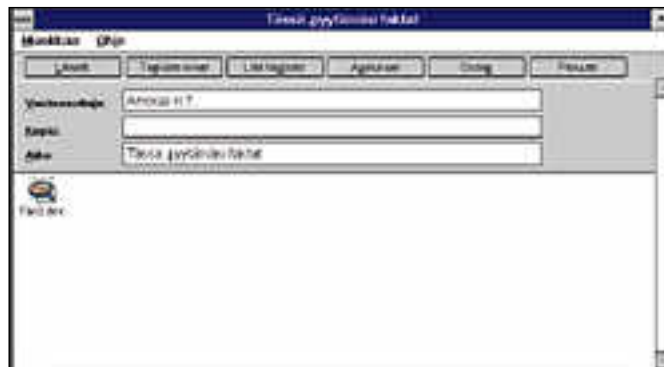
Windows 3.11 mukana tuleva faksiohjelma on At Work -standardin mukainen. Käitellessään se ilmoittaa vastaanottavalle telekopiokoneelle olevansa At Work -laite ja selvittää onko linjan toisessa päässä tavallinen faksi vai At Work -laite. Vastauksen perusteella se päättää missä muodossa dokumentti lähetetään.
