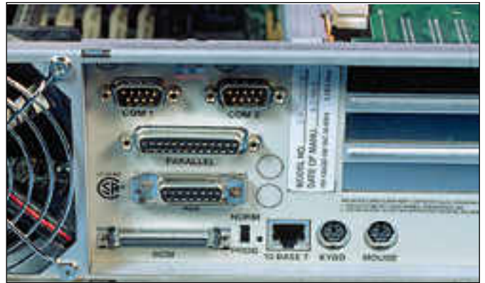
Emolevyn korkea integrointiaste mahdollistaa liittimien keräämisen selkeäksi ryhmäksi. Pienen tilaan saadaan kaikki tarpeelliset liittimet. Intergraphissa on tavanomaisten liittäntöjen lisäksi SCSI-liitäntä sekä 10base-T- ja AUI-verkkoliittimet.
