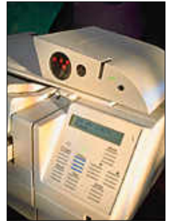
Ricohin tulostimessa on liitäntä faksimodeemille ja se toimii itsenäisenä vastaanottavana faksina. Tulostinohjaimesta voidaan valita tulostuuko paperi omasta kirjoittimesta vai lähteekö se faksina maailmalle.
