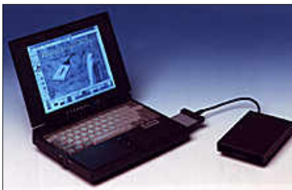
CityNote-muistikirjamikron vakiovarustukseen kuuluva levykeasema liitetään PCMCIA-korttipaikkaan.
