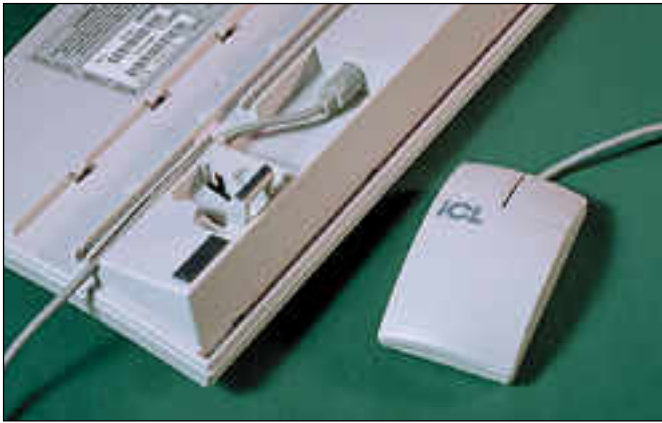
ICL:n näppäimistöissä on hiiren liitin näppäimistön pohjassa, joka on PC-koneissa harvinainen, mutta mukava ratkaisu. Koneen takaa tulee vain yksi johto, eikä pitkä hiiren johto sotkeudu pöydän pape-reihin. Huoliteltua viimeistelyä.
