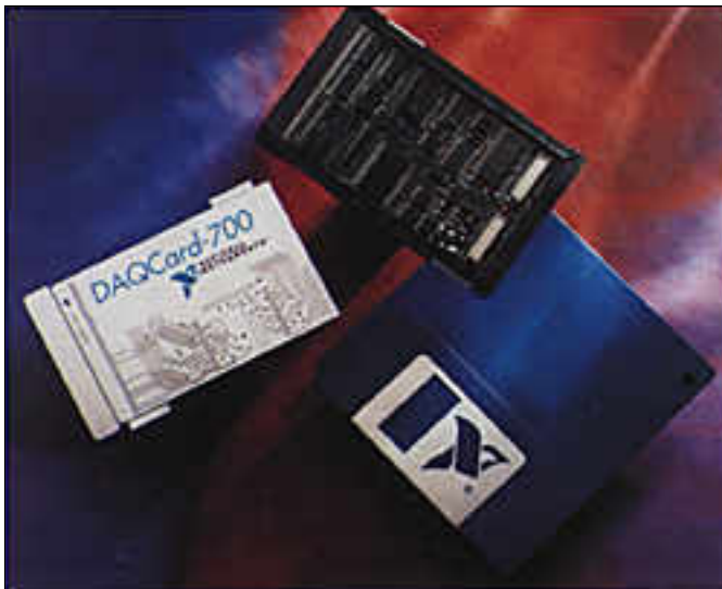
National Instrumentsin tiedonkeruukortti tulee markkinoille keväällä. Siinä on 16 analogista sisäänmenoa ja AD-muunnin, joka ottaa jopa 80000 näyttettä sekunnissa. Hinta asettunee 7400 markkaan.
