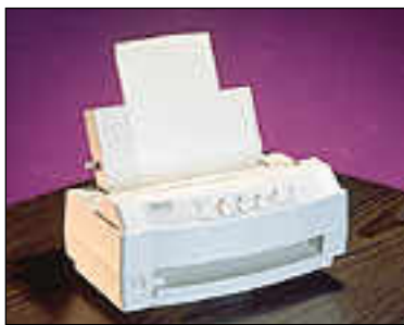
Brother vaatii vähiten pöytätilaa, sillä sekä tyhjät arkit että valmiit tulosteet tulevat pystyyn kirjoittimen päälle.
