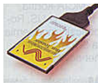
Bus Toaster -SCSI-sovittimen voi asentaa käynnissä olevaan koneeseen. Liittimestä huolimatta kortti on vain 3,3 millimetriä paksu.
