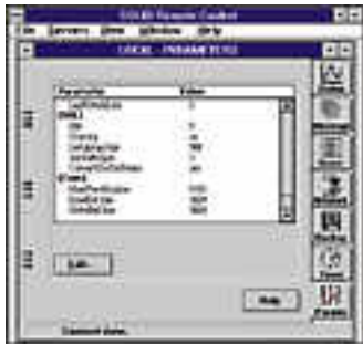
Palvelimen konfigurointi on yksinkertaista ja useissa tapauksissa se voidaan jättää kokonaan tekemättä. Kuvassa palvelimen puskurikokojen asetus.
