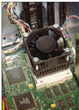
Kookkain prosessorin päälle kiinnitetty tuuletin oli Morse'ssa.
