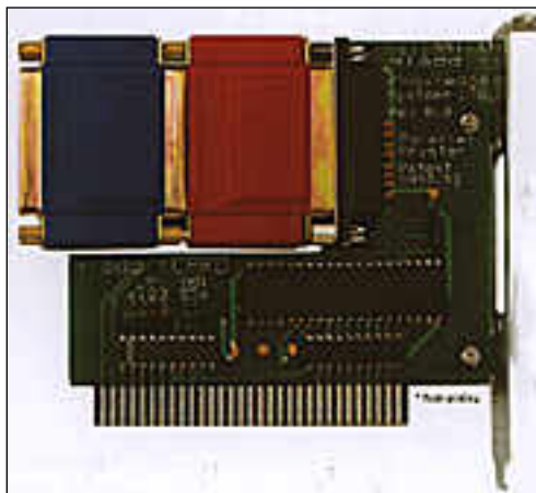
Ohjelmien luvattoman käytön estäviä suojausmoduleja, voidaan kuvan lisäkortin avulla asentaa siten, että ne tulevat mikron kuorien sisäpuolelle.
