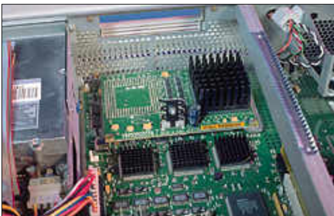
90 megahertsin Pentium toimii 3,3 voltin jännitteellä. Tavallisesti emolevyllä on erillinen 3,3 voltin regulaattori. Intergraph on ratkaissut jänniteasian tekemällä prosessorille piirin ja kannan väliin tulevan piirikortin, joka alentaa viiden voltin jännitteen 3,3 volttiin.
