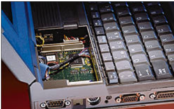
Texas TravelMaten liittimet ovat poikkeuksellisesti koneen vasemmassa reunassa. Pienen luukun alta paljastuu paikka muistilaajenukselle.
