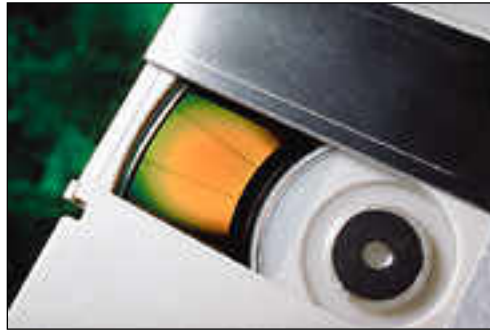
128 megatavun levykkeessä kaikki sektorit ovat siistissä järjestyksessä. Sisimmät urat ovat paljon lyhyempiä kuin uloimmat. Sisimmät urat rajoittavat näin tallennustiheyttä.
