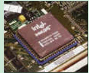
Tyypimerkinnästä huolimatta DX4 on vain kaksin- tai kolminkertaisella sisäisellä kellotaajuudella toimiva 486-prosessori.
