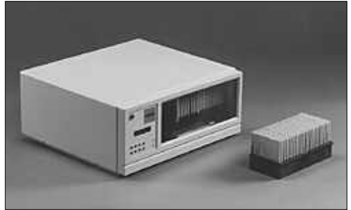
3,5 tuuman magneto-optiselle levyille voi parhaimmillaan tallentaa 384 megatavua tietoa. Kalifornialaisen MOST, Inc.:in pöytämalliseen vaihtajaan mahtuu 22 levyä, jolloin tallennuskapasiteetti on jopa 8,4 gigatavua eli satakunta hyllymetriä paperia kuvanlukijalla luettuna.
