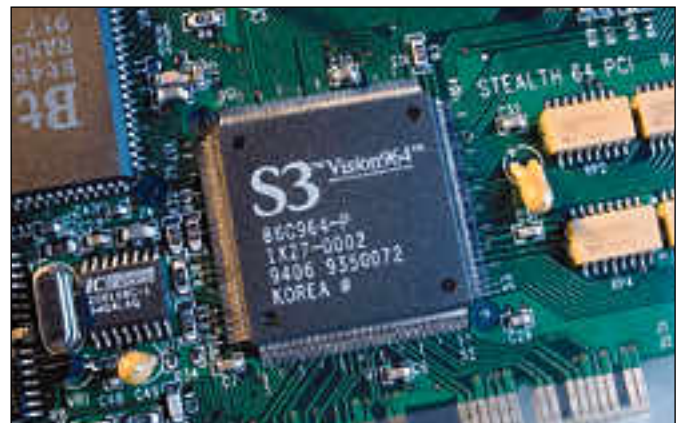
S3:n 64-bittiset kiihdytinpiirit tunnistaa mallimerkinnöistä 864 ja 964. Näistä 864 käyttää D-RAM-muistia ja nopeampi 964 V-RAM-tyyppistä muistia.
