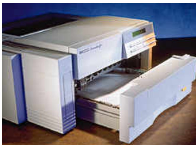
LaserJet 4P:ssä paperikasetti liukuu näppärästi ulos pöydän pintaan pitkin. Sitä ei tarvitse täyten jälkeen pujotella kiskoille.
