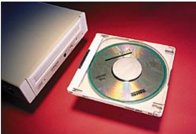
Caddy eli levykotelo suojaa CD-levyä, mutta maksaa useita kymppä. Niitä harvemmin tulee ostettua joka sovellukselle.
