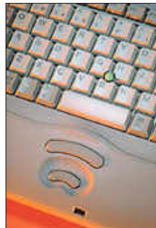
Toshiba on ottanut käyttöön alunperin IBM:n kehittämän ohjaussauvan. Näin pienessä koneessa se ei ole toimiva ratkaisu.
