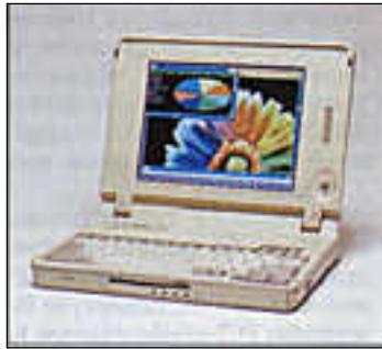
Compaq LTE Elite -muistikirjamikrossa on sisäänrakennettu virtalähde. Mikro painaa kuitenkin vain 3,1kiloa.
