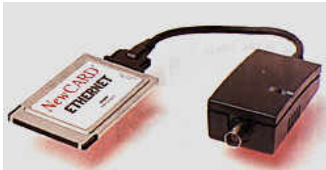
Ethernet-kortin liittännät ja linjamuunnimet on usein sijoitettu omaan laatikkoon. Näin voidaan myös helposti vaihtaa BNC-liittin RJ45-liittimeksi.
