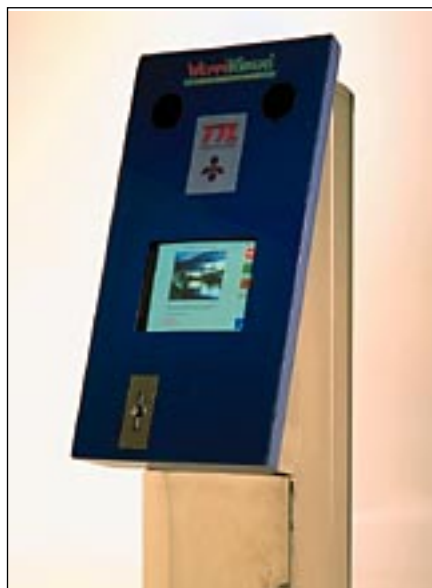
Web-kioskissa on SUNin työasema, jota ohjataan 20-tuumaisella kosketusnäytöllä. Maksuväliseen toimii puhelimesta tuttu maksukortti.
