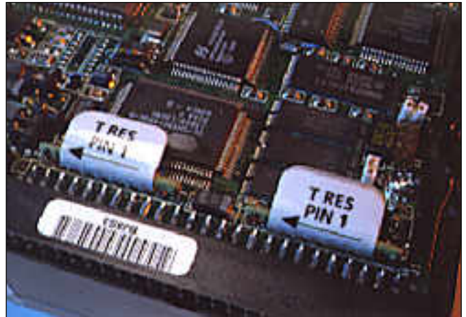
SCSI-väylä täytyy aina päättää terminaattoriin. Kaikissa levyissä on terminaattori, mutta jos SCSI-laitteita on useampia se täytyy kytkeä pois. Maxtorin irrotettava vastusverkko on näppärä, mutta katoaa helposti. Nuoli osoittaa ykköspinniä.
