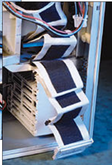
Digitalin palvelimessa kaapelit joutuvat koville liian ahtaissa ja teräväreunaisissa aukoissa.
