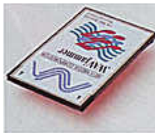
Multimediaesitysten pitäjille äänikortti on pakollinen hankinta. WAVjammerin mukana tulee MS Sound System 2.0. Erillisessä liittintärasiasissa on linjatason sisään- ja ulosmenot, sekä mikrofonin ja kuulokeliitäntä.
