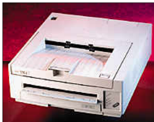
Fujitsun paperirata on mutkikas, eikä siinä ole läpisyöttöä.
