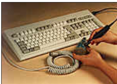
Cherry on tuonut markkinoille näppäimistön, jossa on sisäänrakennettu viivakoodien lukulaite.
