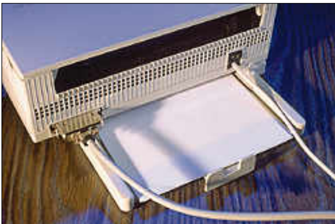
Olivetin koneistoa käyttävissä kirjoittimissa paperi lisätään hankalasti kirjoittimen takapuolelta. Toimenpidettä vaikeuttavat entisestään kirjoittimen ohjauksikaapeli ja virtajohto.
