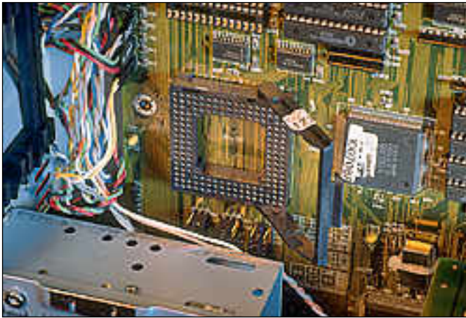
ZIF-tyyppinen prosessorikanta, eli nollavoimakanta toimii siten, että prosessori ensin pudotetaan paikalleen ja sen jälkeen se kiristään kantaansa kuvassa näkyvällä vivulla.
