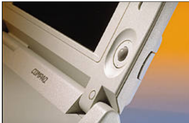
Compaqin ohjainpallo sijaitsee muista poiketen kannessa näytön oikealla puolella. Hiiren näppäimet ovat kannessa pallon takana.
