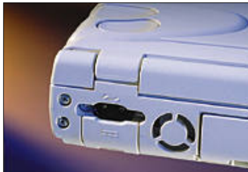
Compaqissa virtalähde on rakennettu mikron sisään, joten ohut virtajohdot liitetään suoraan mikron. Virtajohdon liittimen vieressä näkyy pieni tuuletin.
