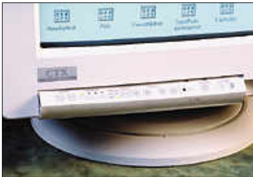
CTX säädetään kalvonäppäimin, jotka aukeavat hyvin näkyville monitorin alareunasta. Normaalkäytössä säätöpaneeli ei ole näkyvillä.
