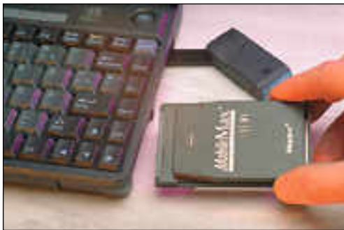
HP Omnibookissa on yksi PCMCIA Type III:n kokoinen paikka, johon saa esimerkiksi laitteen kiintelevyn.
