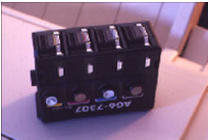
Canonin nelivärinen kirjoituspää suositellaan vaihdettavaksi 10000 tulosteen jälkeen. Kirjoituspään käsittely ei ole vaikeata, mutta suutinten koskettelua on luonnollisesti syytä välttää.
