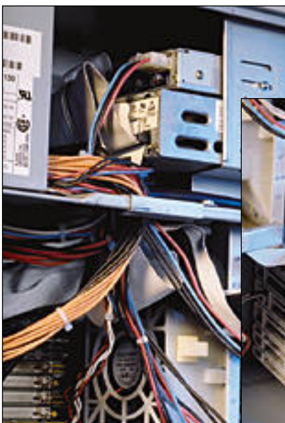
Digitalin palvelimessa kaapelit joutuvat koville liian ahtaissa ja teräväreunaisissa aukoissa.
