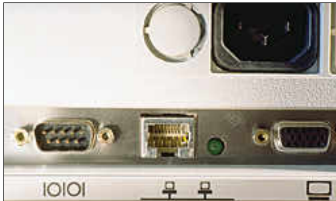
Hewlett-Packardin takaseinässä on emolevylle integroitu 10-Base T -verkkoliitin.
