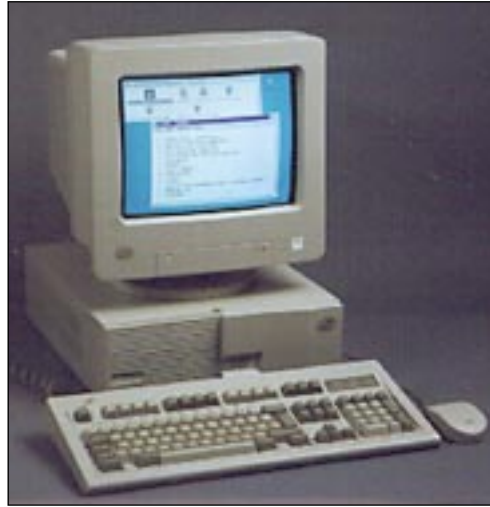
IBM:n uusi toimistokäyttöön suunnattu mikro on nimeltään IBM PC 300. Se on varustettu vaihdettavalla väyläkortilla ja siinä on laajat muistikirjamikrotyyppiset virransäästötoiminnot.
