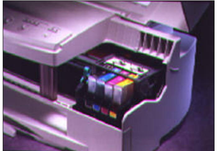
Kirjoituspää ja mustesäiliöt ovat erillisen kannen alla Canon BJC-600:ssa. Sinisävyisiin piirtoheitinkalvoihin ihastuneen ei tarvitse vaihtaa kaikkia värejä sinisen lopputtua.
