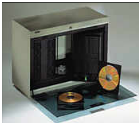
CD-jukeboxissa on kaksi 50 levy makasiinia, joiden välissä oleva noutomekanismi hakee halutun levyn lukuyksikköön.
