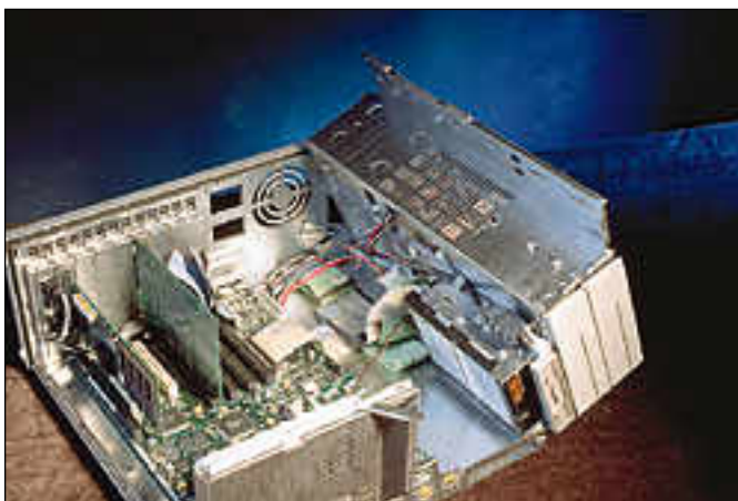
Olivettissa kiintolevylle on tilaa virtalähteen ja levykeasemien alla. Näihin massamuistipaikkoihin pääsee käsiksi kääntämällä virtalähdemoduuli saranoiden varassa sivuun.
