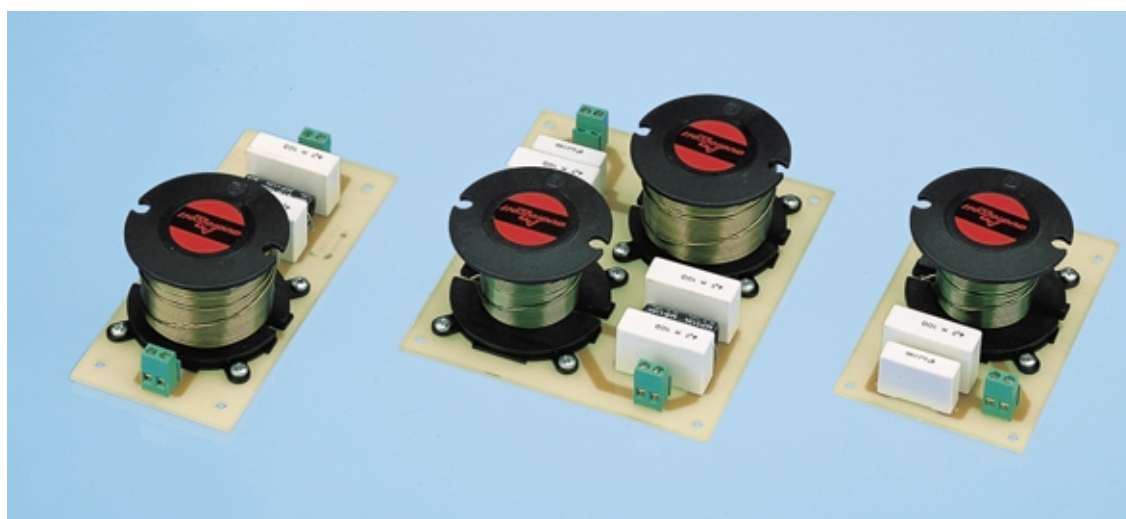
Fig.24 Tutti i filtri a 3 vie sono composti da tre stadi separati. Uno porta le note acute al Tweeter, un altro le note medie al Midrange e l'ultimo le note basse al Woofer.
