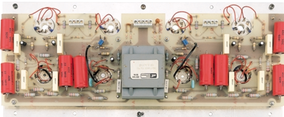
Fig.6 Il circuito stampato dell'amplificatore viene fissato sopra un telaio in alluminio con funzioni di schermo, ad una distanza di 5 millimetri dal lato delle valvole pilota e di 15 millimetri dal lato delle valvole finali (vedi fig.7).
