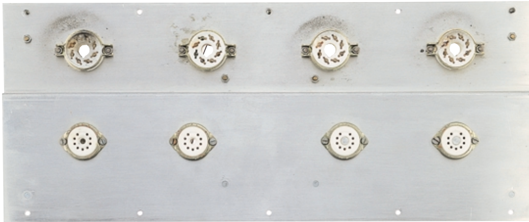
Fig.7 Gli zoccoli delle valvole vengono fissati sopra un telaio in alluminio ripiegato a Z, che funge da schermo per il circuito stampato sottostante.
