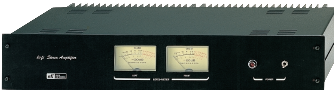
Fig.1 Foto del mobile per l'amplificatore con finali Mospower visto frontalmente. Il pannello vi viene fornito già forato e completo di disegno serigrafico. Nella foto a destra è visibile la parte posteriore del mobile con le prese di entrata BF, quelle di uscita per i due altoparlanti e i tre portafusibili per gli altoparlanti e per la presa di rete dei 220 volt.
