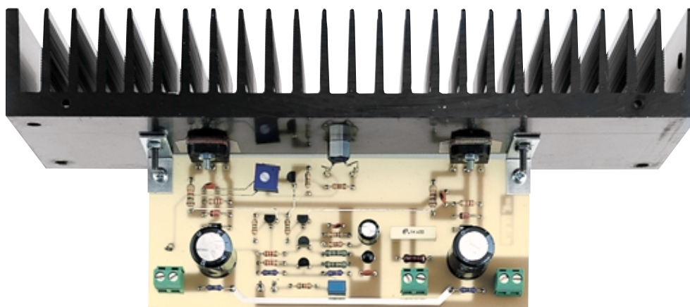
Fig.10 Foto dello stadio finale dell'amplificatore con due Mosfet già completo della sua aletta di raffreddamento. Per realizzare un finale Stereo occorrono due di questi circuiti.
