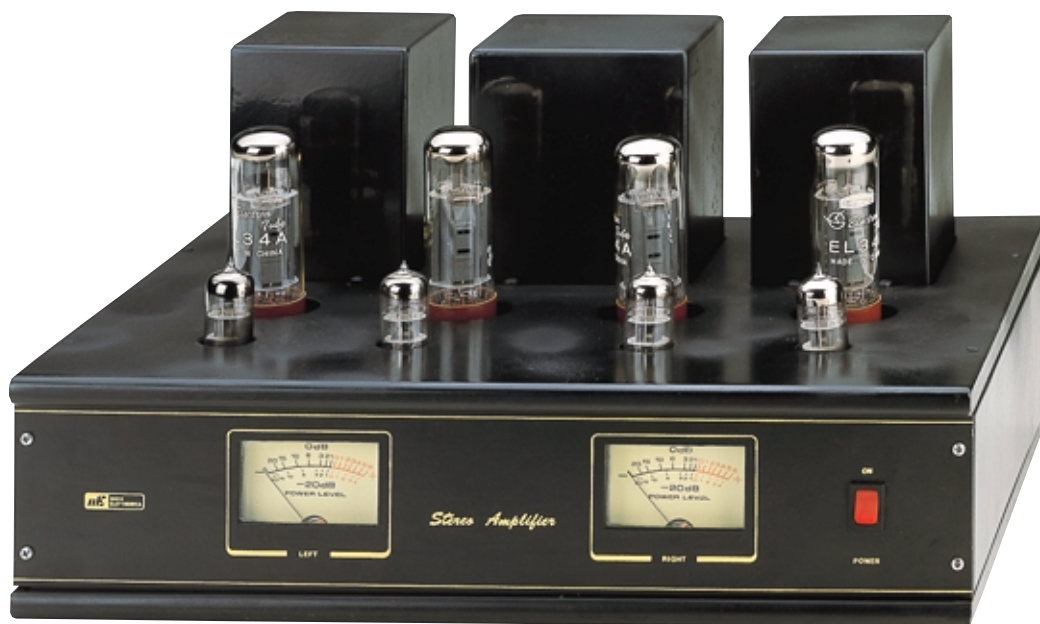
Fig.4 Il nostro amplificatore è in grado di fornire 60+60 watt musicali, pari a 30+30 watt RMS, se si utilizzano 4 valvole EL.34 (vedi foto sopra), e di fornire 80+80 watt musicali, pari a 40+40 watt RMS, se si utilizzano 4 valvole KT.88 (vedi foto sopra il titolo).
