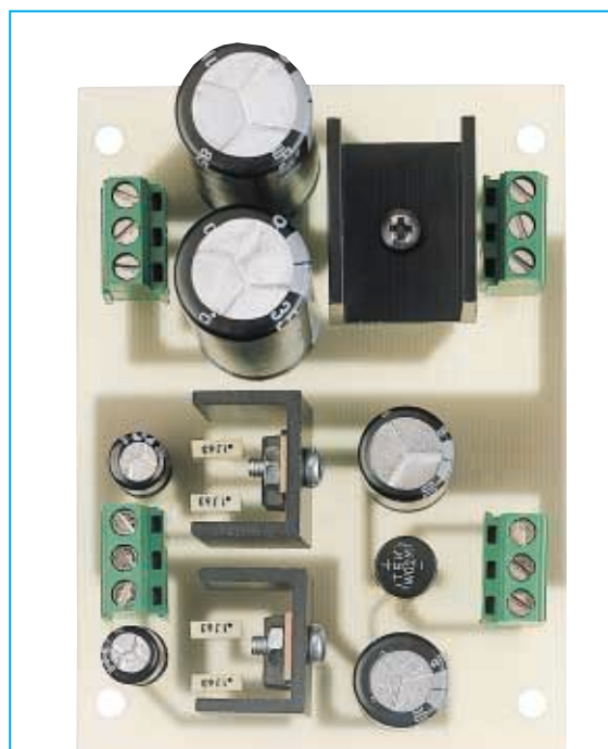
Fig.6 Foto dello stadio di alimentazione LX.1286. Sul ponte raddrizzatore RS1 e sugli integrati IC1-IC2 occorre applicare una piccola aletta di raffreddamento.
