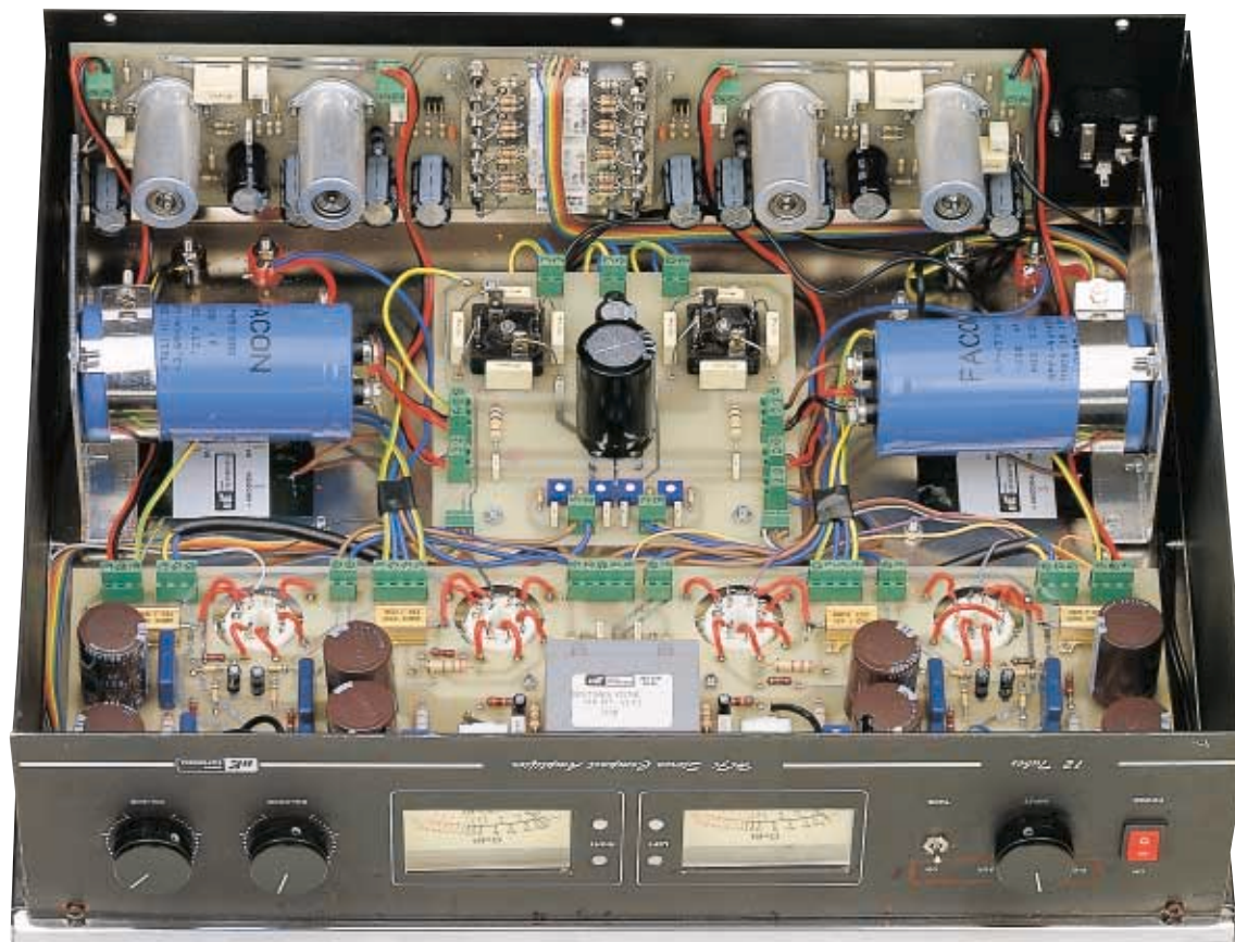
Fig.11 In questa foto, presa a mobile capovolto, si vede chiaramente lo stadio preamplificatore LX.1320 fissato sul pannello posteriore del mobile. Tra questo circuito stampato e il pannello del mobile vanno fissati i distanziatori metallici da 5 mm (vedi fig.2). Controllate attentamente che non vi sia qualche terminale di qualsiasi componente talmente lungo da andare a toccare il metallo del mobile, perché in queste condizioni il circuito non funziona.
