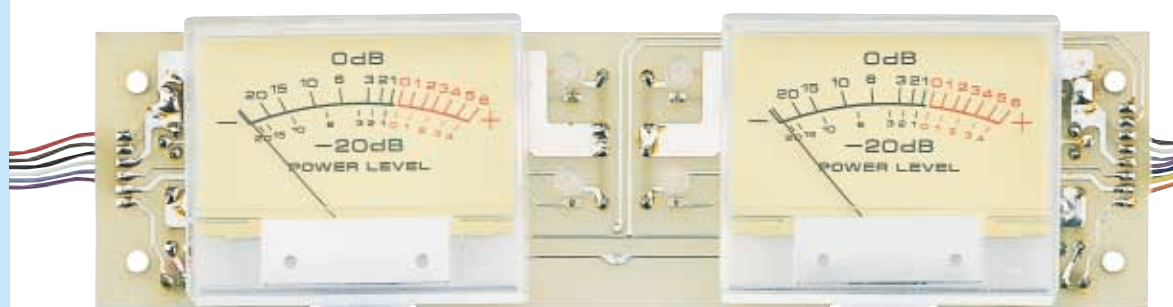
Fig.12 I due strumentini del Vu-Meter vanno applicati sul circuito stampato LX.1322 (vedi schema pratico in fig.13). Questo stampato deve poi essere fissato sul pannello frontale del mobile con i quattro distanziatori plastici con base autoadesiva inclusi nel kit (vedi fig.2).
