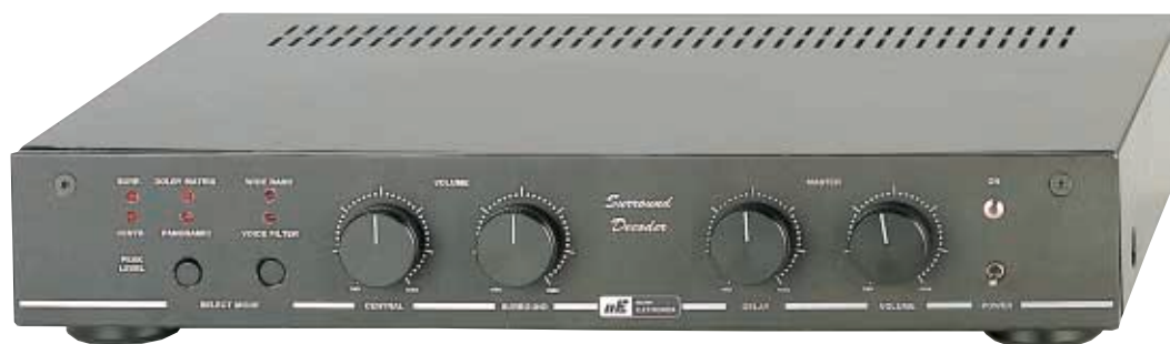
Fig.2 Foto del pannello frontale del decoder Dolby Surround. Commutando il decoder in posizione Panoramic riuscirete ad ottenere un suono polifonico anche con normali CD e Videocassette sprovvisti di Dolby e ovviamente anche con l'audio dei programmi TV.
