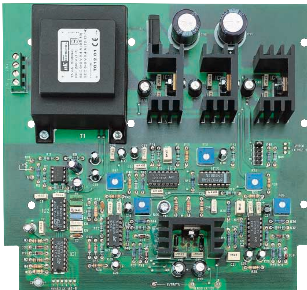
Fig.7 Foto della scheda base siglata LX.1192. Come potete vedere, su questa scheda trovano posto tutti i componenti necessari all'impedenzometro - reattanzometro, compreso lo stadio di alimentazione, con la sola esclusione dei componenti dello stadio display (vedi fig.12) che devono essere montati su un'apposita scheda che andrà collocata sul pannello frontale del mobile. Gli integrati stabilizzatori IC11-IC12-IC13 e l'amplificatore di potenza IC4 devono essere montati sulle loro alette di raffreddamento.
