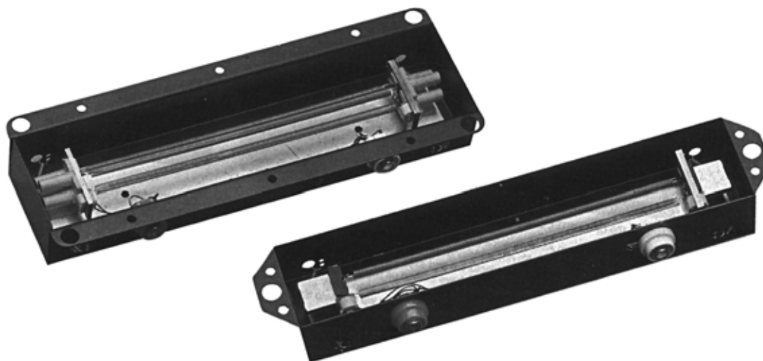
Fig.2 Per generare l'effetto Riverbero si utilizzavano molti anni fa delle molle. A una estremità veniva collegata una elettrocalamita per farla vibrare e all'estremità opposta un pick-up magnetico che, captando il suono vibrato, simulava l'effetto Cattedrale.
