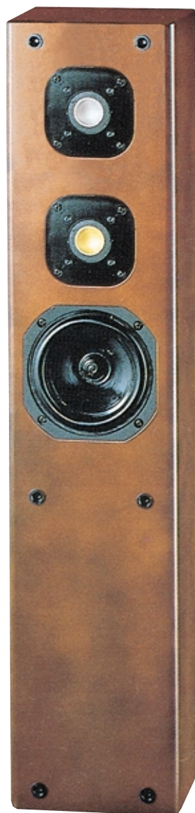
Fig.25 Questa Cassa Acustica con un volume di circa 80 litri risulta molto valida per accogliere tre altoparlanti, un Tweeter, un Midrange e un Woofer.
