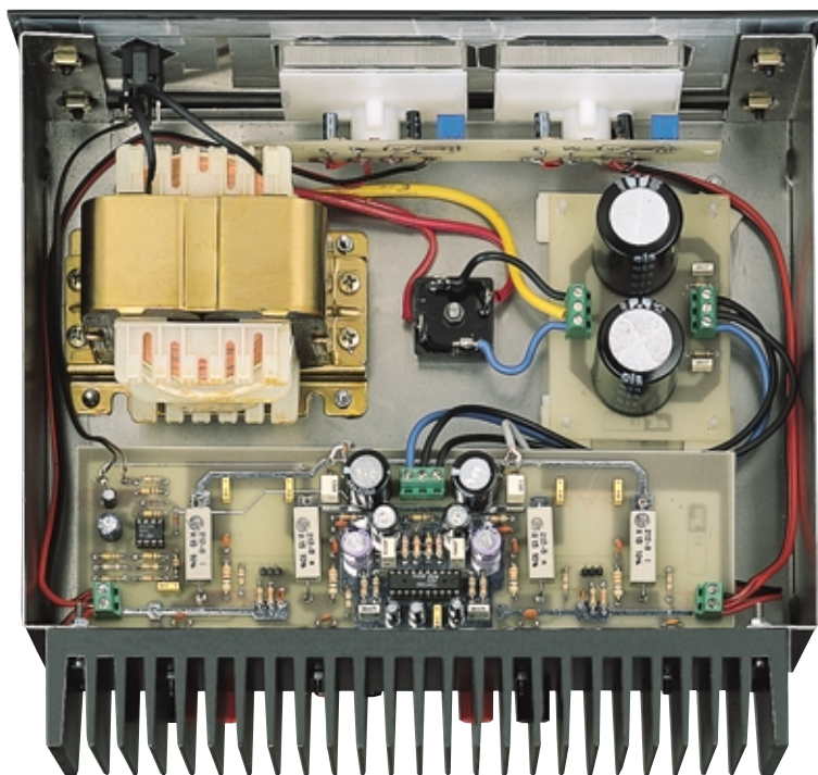
Fig.16 Vista del mobile dal lato posteriore. Il trasformatore di alimentazione ed il ponte raddrizzatore vanno fissati sulla base metallica del mobile.
