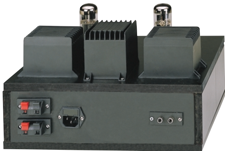
Fig.5 Sul lato posteriore del mobile dovrete fissare a sinistra le due prese d'uscita per gli altoparlanti e a destra le due prese RCA d'ingresso. All'ingresso del finale potete collegare qualsiasi preamplificatore, a transistor, a fet o a valvole, perché il circuito accetta qualsiasi valore d'impedenza. E' quindi possibile collegare anche il segnale prelevato dal preamplificatore a valvole LX.1140, pubblicato nel primo volume, non dimenticando però di ruotare il trimmer R1 a circa metà corsa per non saturare l'amplificatore.
