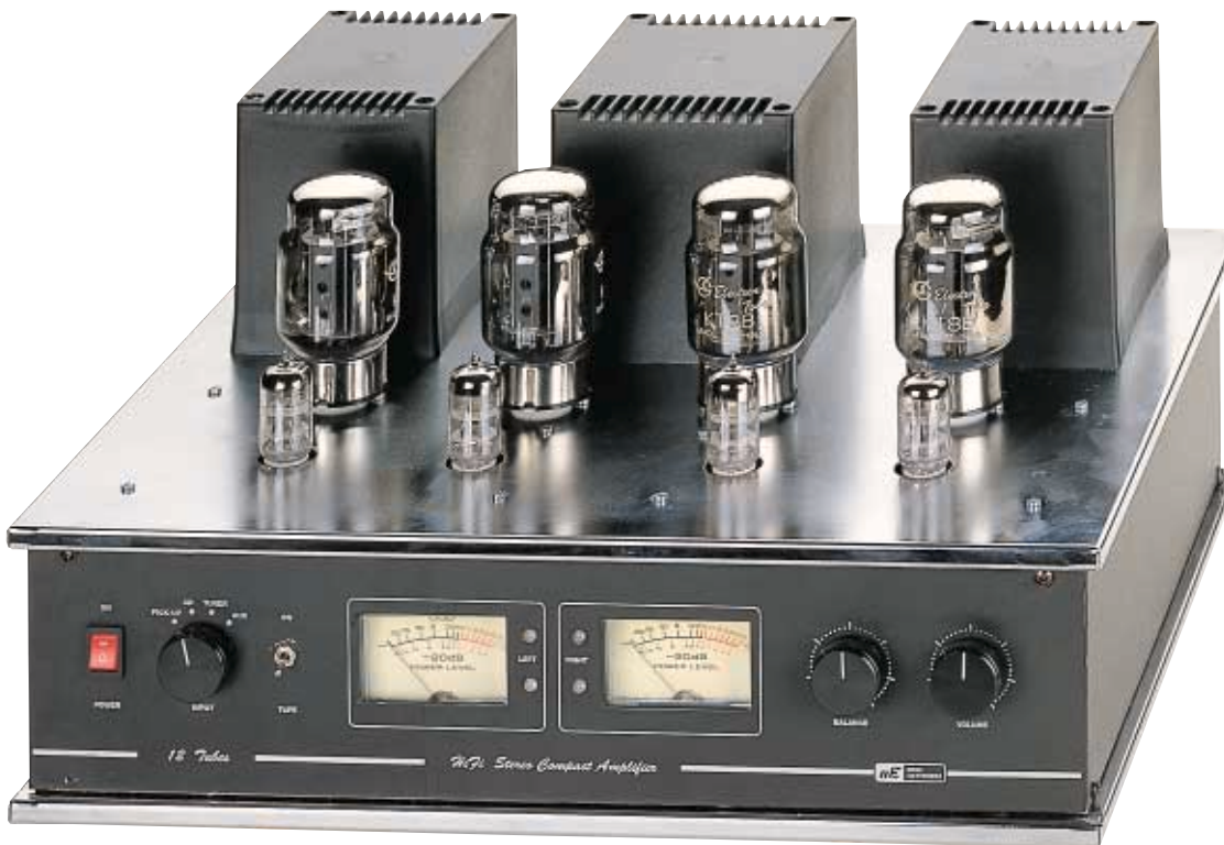
Fig.19 Il mobile che abbiamo fatto preparare per questo progetto è in ferro nero opaco ed è rifinito da una mascherina frontale forata e serigrafata e da una mascherina posteriore forata. La scelta del piano superiore CROMATO ha reso l'amplificatore esteticamente molto elegante, in particolar modo quando tutti i filamenti delle valvole risultano accesi.
