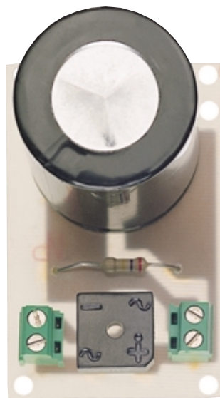
Fig.11 Sul circuito stampato siglato LX.1239 dovreste montare il ponte raddrizzatore RS1, il condensatore elettrolitico C9 e la resistenza R14. Nella fig.12 sono visibili tutti i collegamenti che dovreste effettuare.
