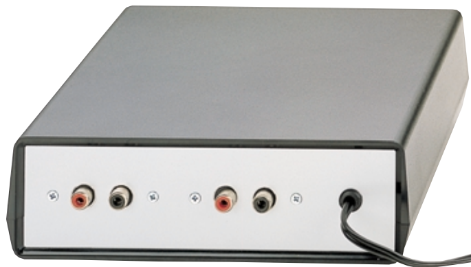
Fig.6 Sul pannello posteriore del mobile andranno fissate le due bocche per l'ingresso e per l'uscita del segnale BF.
