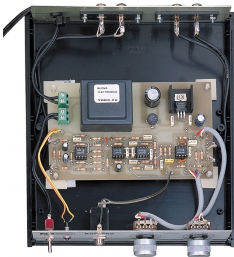
Fig.2 In questa foto potete vedere come va collocato il circuito stampato all'interno del suo mobile plastico.
