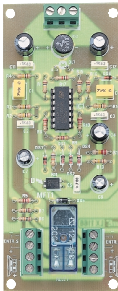
Fig.7 Foto del circuito montato che servirà a proteggere le vostre casse acustiche.
