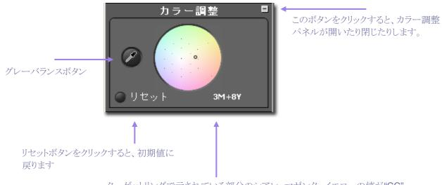
ターゲットリングで示されている部分のシアン、マゼンタ、イエローの値が"CC" (色補正フィルター単位)で表示されます。
