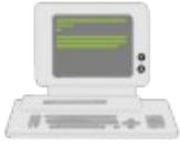
Gerät, bestehend aus Tastatur, Monitor und eventuell Maus, jedoch *ohne* eigene Einrichtungen zur Verarbeitung von Daten. Ein dummes Terminal muß an einem Computer angeschlossen sein, um funktionieren zu können.
