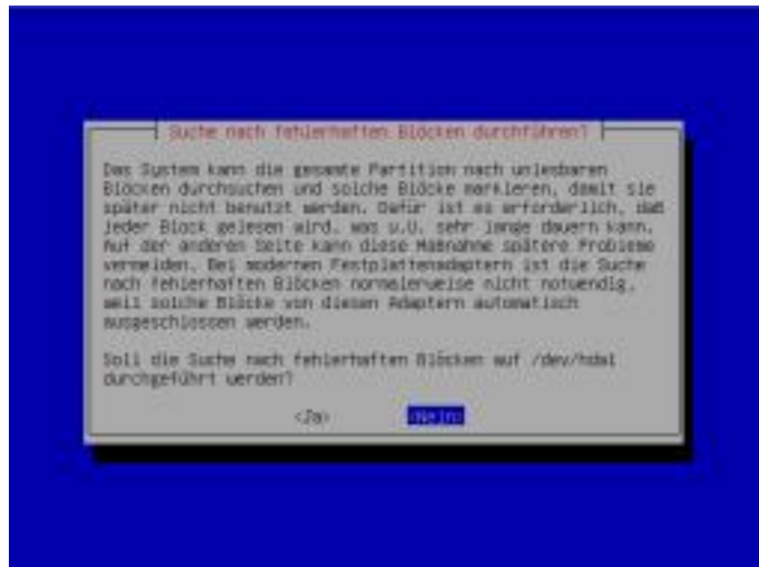
Abbildung 2-22. Überprüfung auf defekte Blöcke
