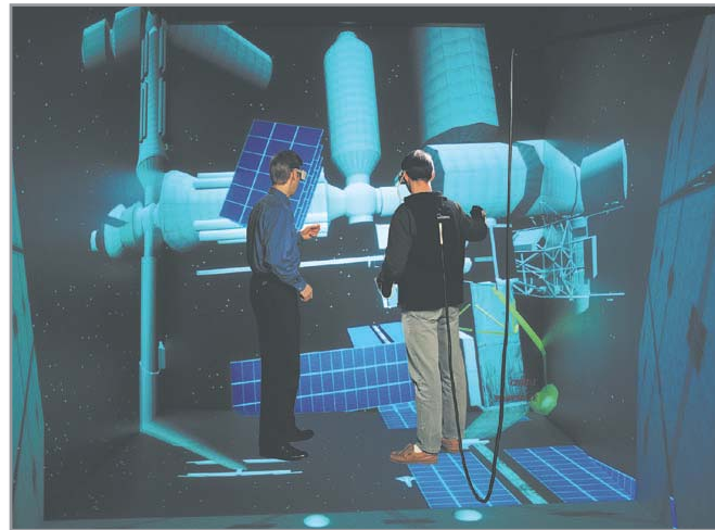
◀ Рис. 1. Устройство CAVE, используемое преимущественно для сложных научных работ
