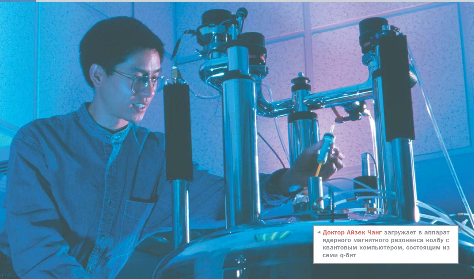
◀ Доктор Айзек Чанг загружает в аппарат ядерного магнитного резонанса колбу с квантовым компьютером, состоящим из семи q-бит
