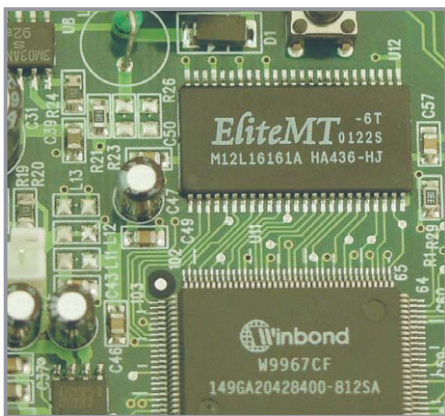
▲ На платах внешних ТВ-тюнеров оперативная память довольно обычное явление. Она используется в качестве буфера при видеозахвате
