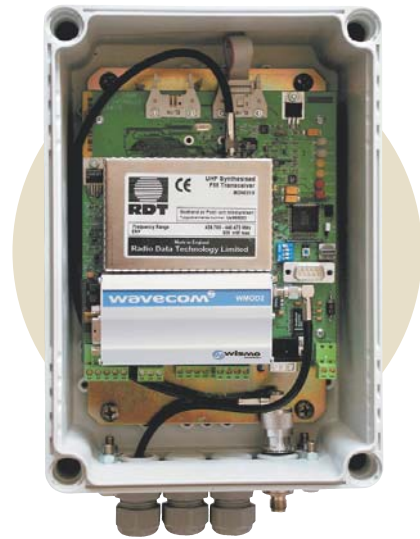
▲ Внутреннее устройство приемопередающей антенны
