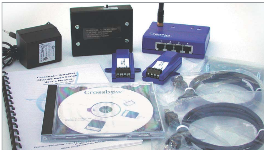
▲ Комплект для организации сегмента гибридной сети включает в себя соединительные кабели, точку доступа, блок питания и необходимое ПО
