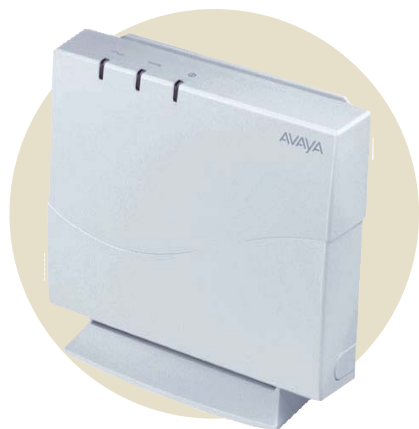
▲ Небольшая коробочка скрывает в себе точку доступа в беспроводную сеть
