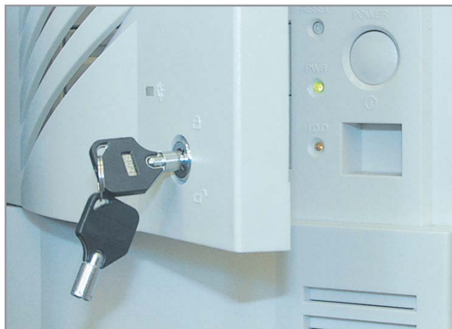
◀ Самый распространенный и примитивный вид защиты — маленький замочек на корпусе системного блока или Mobile Rack
