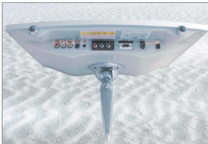
◀ У большинства телевизоров разъемы расположены снизу, что существенно затрудняет подключение
