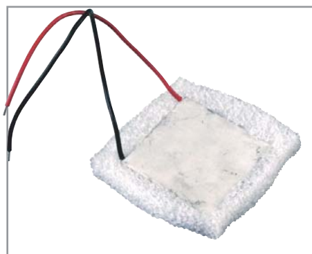
▲ Элемент Пельтье, размещенный в специальном поролоновом кожухе
