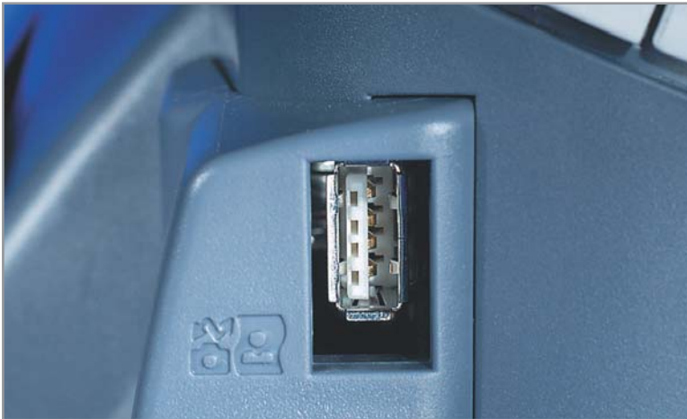
▲ Canon i470D: этот компактный фотопринтер умеет работать через отдельный USB-интерфейс только с цифровыми фотоаппаратами Canon
