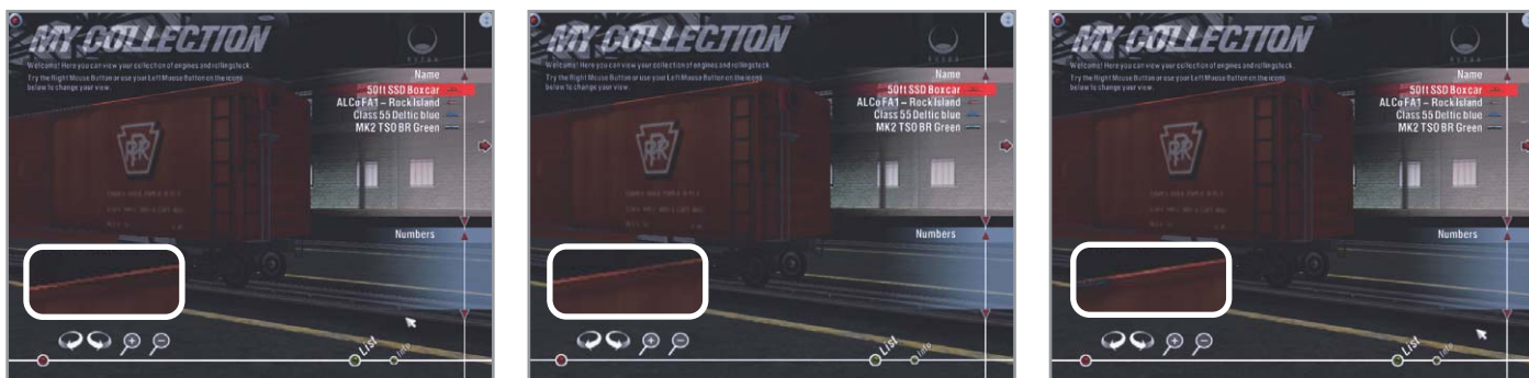
▲ Различие видно невооруженным взглядом. Слева — полноэкранное сглаживание отключено, по центру — 4xAA с драйвером Detonator 43.51, справа — 4xAA с драйвером Detonator 44.67. Как видно, качество сглаживания при использовании драйвера версии 43.51 уступает эталонному
