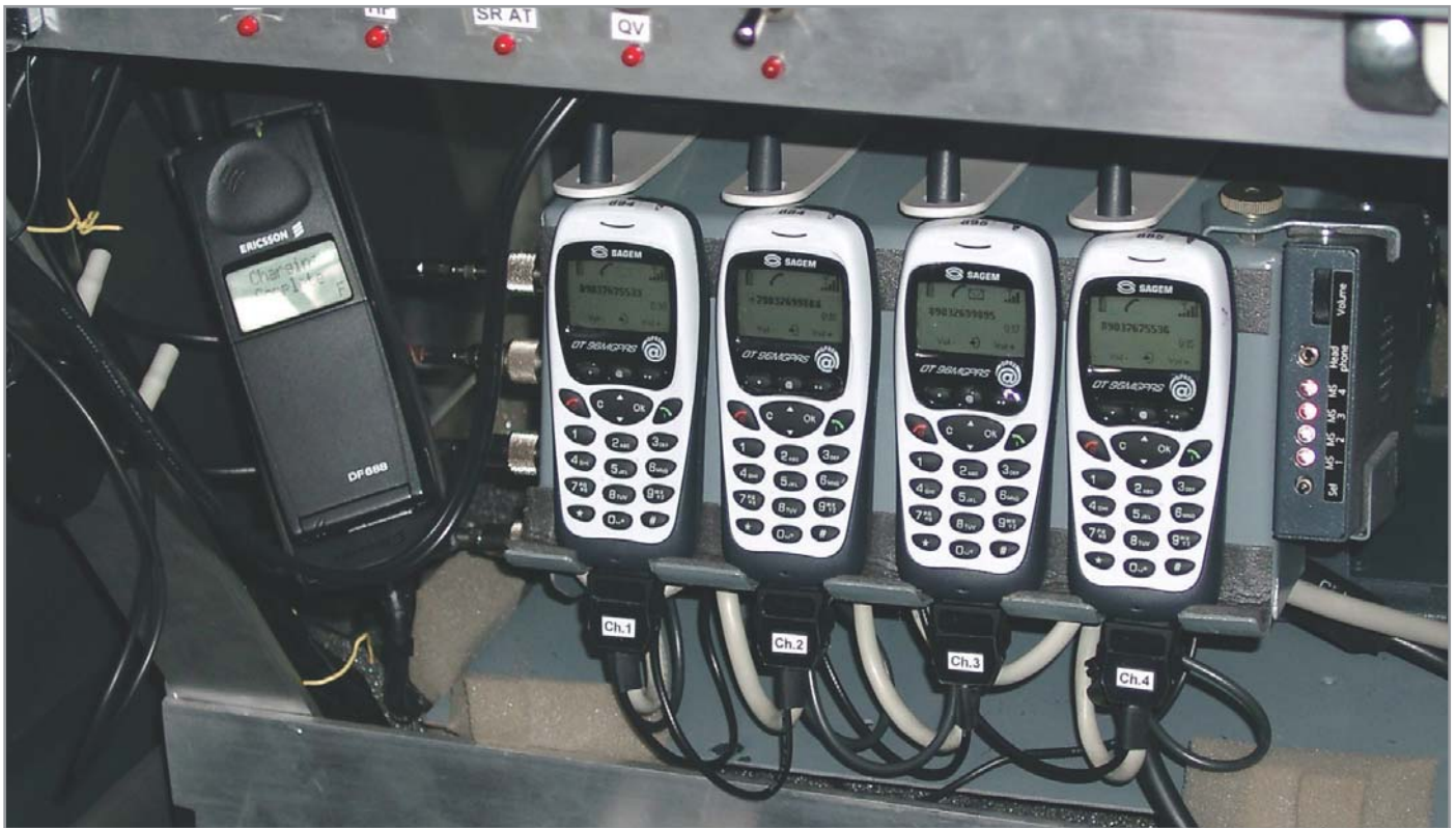
▲ Мониторинг качества передачи речи: несколько трубок непрерывно передают специально подготовленную фразу, голос проходит «полный круг» по сети, возникшие в процессе передачи искажения анализируются
