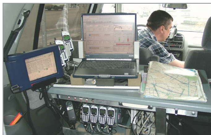
▲ Передвижная лаборатория мониторинга сети («Би-лайн»). Компьютеры, специально оборудование, полтора десятка работающих телефонов, GPS
