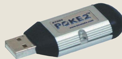
▲ Рис. 4. Небольшой адаптер позволяет создать bluetooth-сеть на ПК
