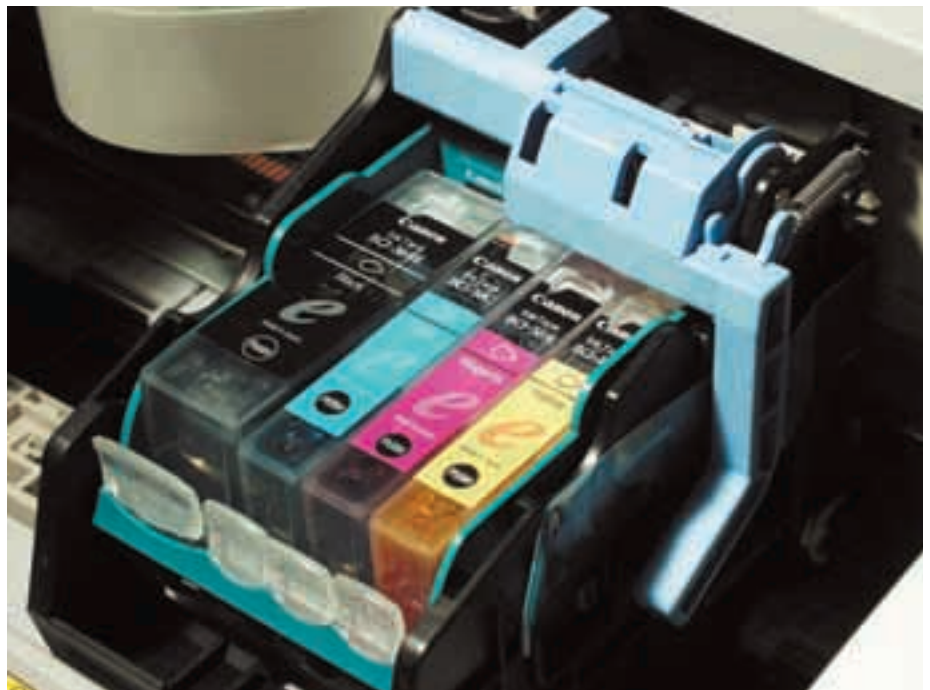
Tiskárny Canon S400 (na obrázku) a Xerox DocuPrint M750 používají oddělené zásobníky inkoustu.
