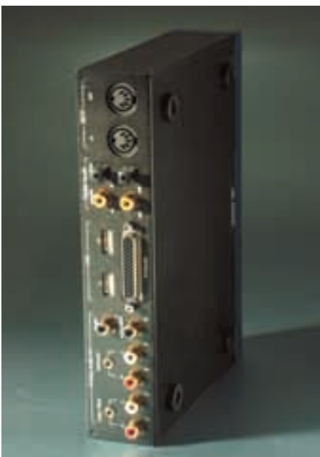
Pohled zezadu na konektory, neobvyklé jsou výstupy pro reproduktory současně v cinch i jack provedení.
