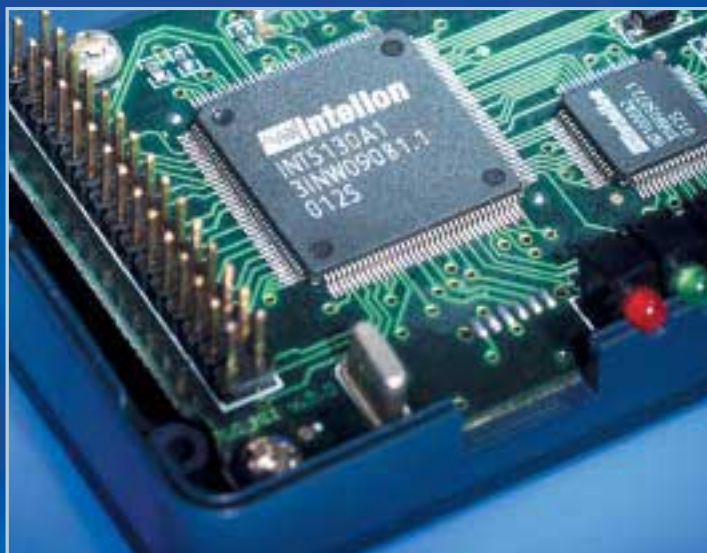
Srdce i mozek: Tou nejdůležitější součástí všech adaptérů HomePlug je čipová sada od firmy Intellon. Na obrázku je čip první generace, který ještě tvoří dvě součástky.
