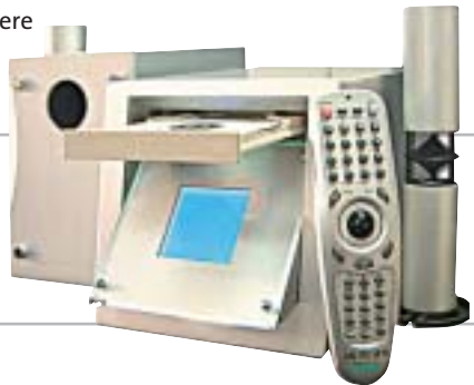
Il Q-Box è un lettore di Cd, Dvd, Mp3 e non necessita di sistema operativo
