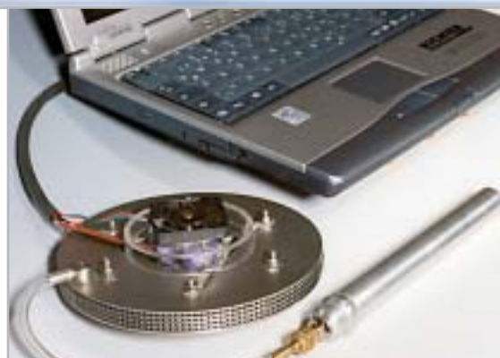
Prototipi: la piccola microcella a combustibile (a sinistra) può produrre 250 milliwatt di energia. La cella a combustibile con convertitore di tensione integrato (a destra) alimenta dall'esterno un notebook
