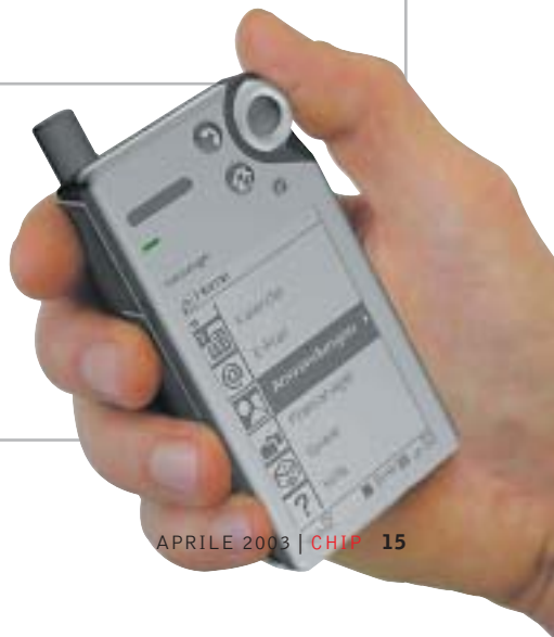
Mobile Cinema L'AV340 di Archos può registrare (e riprodurre) sul disco fisso da 40 Gb circa 80 ore di film in formato Mpeg4
