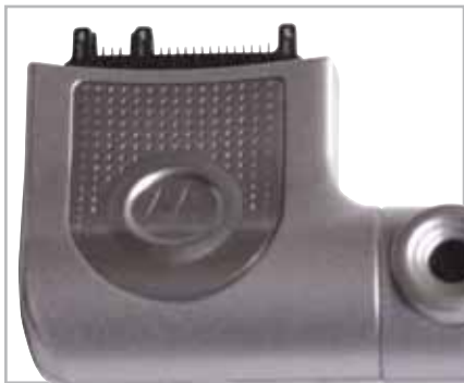
La fotocamera esterna del Motorola T720i ha l'ottica ruotabile per facilitare gli autoscatti
