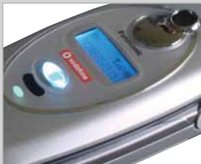
Il secondo display del GD87 e il led che si accende quando si riceve una chiamata
