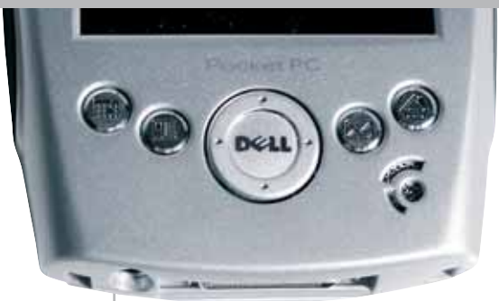
Il set di pulsanti consiste in un pad a croce e quattro tasti personalizzabili
