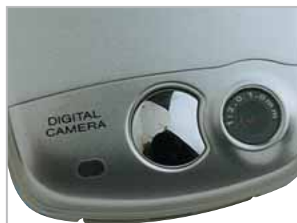
Sharp GX10: l'ottica della fotocamera è posta nella parte superiore del guscio, con a fianco lo specchio per l'autoscatto
