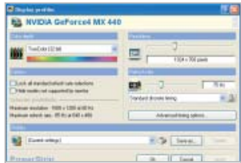
Dal pannello Display profiles si può personalizzare il refresh rate per ogni risoluzione video
