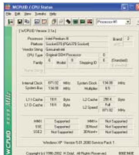
WCPUID mostra informazioni base sulla Cpu, ma anche dettagli tecnici approfonditi attraverso i bottoni di interrogazione presenti sulla barra in alto
