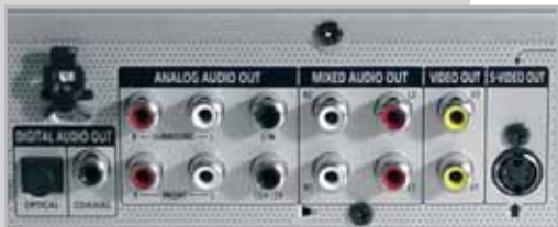
La presenza di connettori RCA per ognuno dei canali permette il collegamento del player anche a sistemi amplificati di casse multicanale
