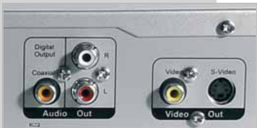
Connettori ridotti all'osso: per quanto riguarda l'audio digitale è presente solo l'uscita coassiale Ac-3, in aggiunta agli RCA stereo
