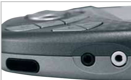
La cuffia stereo dispone di due connettori separati posizionati sul fianco dell'apparecchio
