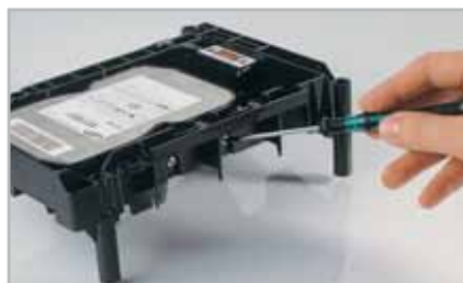
24 Per smontare il disco fisso originale, togliere le viti laterali che lo fissano all'alloggiamento in plastica
