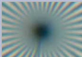
Scanner piano a 4.800 dpi: aumentando la risoluzione, le scalettature scompaiono, ma la nitidezza resta sostanzialmente invariata
