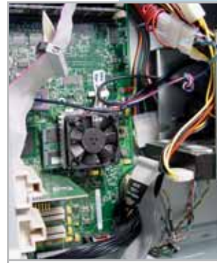
La ventola per pc montata sul processore del Mac
