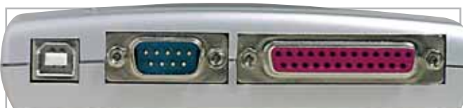
Gli otto connettori consentono di collegare i dispositivi più diversi e di utilizzare il Sitecom come replicatore di porte per un notebook
