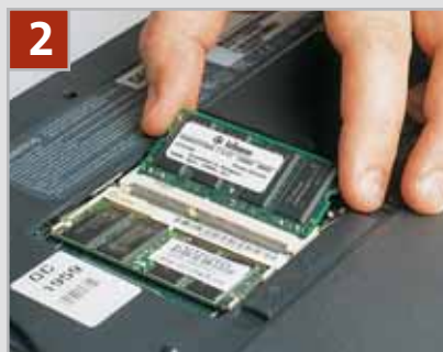
2 L'inserimento corretto del nuovo modulo è aiutato dalla piccola tacca sul lato dei contatti
