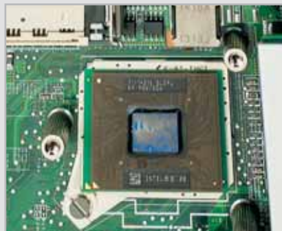
Pentium III mobile: questa Cpu (PIII/900) in formato Micro-Pga2 può essere sostituita
