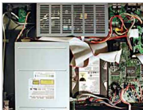
L'interno del C.A.R. 4000: si notano l'hard disk Seagate da 40 Gb e il lettore, che non è altro che un Cd-Rom per pc
