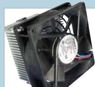
Diminuendo la tensione positiva della ventola, se ne può ridurre velocità e rumore
