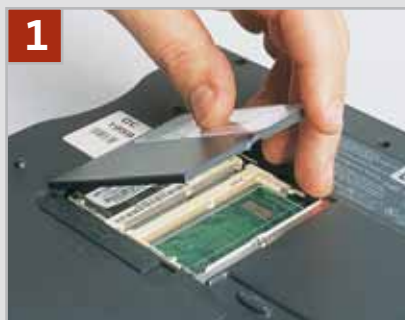
1 Liberare l'alloggiamento delle Dimm: la copertura dei moduli Ram si trova di solito sulla parte inferiore del case
