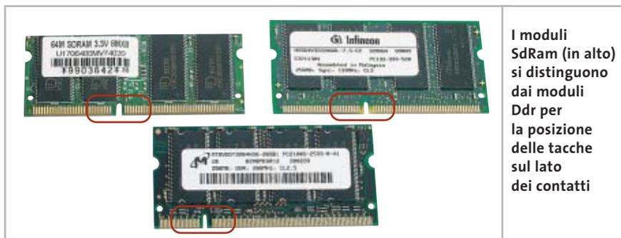
I moduli SdRam (in alto) si distinguono dai moduli Ddr per la posizione delle tacche sul lato dei contatti
