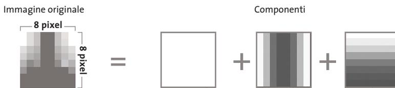
L'immagine viene suddivisa in blocchi di 8 x 8 pixel per ciascuna componente. Ciascun blocco si può ricostruire a partire da 64 motivi base (frequenze). La Dct stabilisce quali frequenze compongono un dato blocco; quanto più l'immagine originale è semplice, tanto meno saranno i motivi contenuti in ciascun blocco
