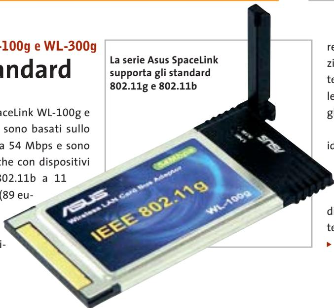
reless in cui si trova. Offre un raggio d'azione particolarmente ampio grazie all'antenna interna e a quella esterna orientabile, che facilita la ricerca della posizione migliore per la ricezione.
