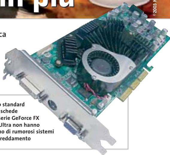
di calore e una corrispondente rumorosità elevata della ventola di raffreddamento necessaria. La memoria è la classica Ddr, un passo indietro rispetto alle Ddr II utilizzate dalle GeForce FX 5800. Con i nuovi effetti CineFX 2.0 c'è inoltre più spazio per la gestione dei Pixel Shader e l'UltraShadow offre ai programmatori potenti strumenti per ottimizzare la gestione delle ombre.
