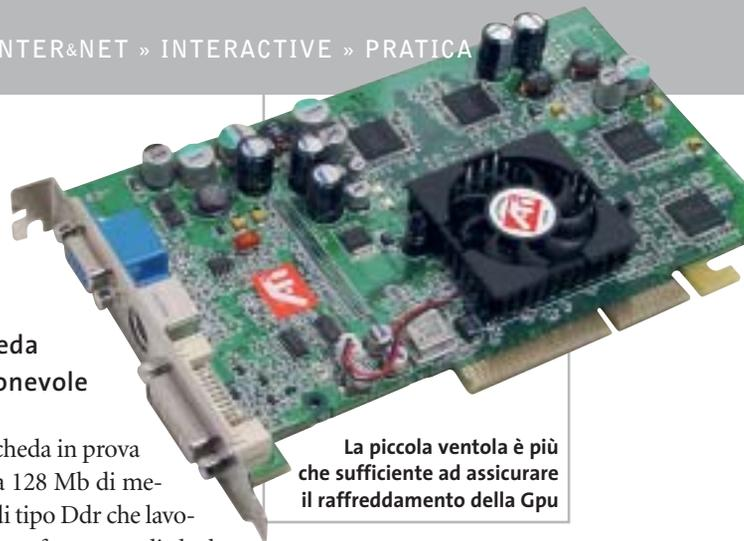
no messe in evidenza le potenzialità delle unità pixel e vertex shader (come è il caso del benchmark CodeCreatures). Se si tiene conto poi che la frequenza di clock della Gpu Radeon 9600 Pro è nettamente superiore, 400 MHz contro 275 MHz, si può concludere che la nuova scheda non rappresenta certo un'evoluzione della Radeon 9500 Pro come la sigla potrebbe far pensare.
