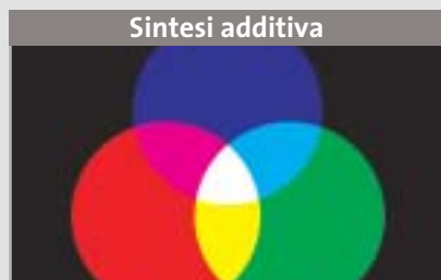
Rgb: sullo schermo nero del monitor i colori sono generati dalla miscela di luce rossa, verde e blu
