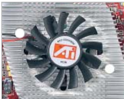
Forma delle alette a parte, il sistema di raffreddamento della Gpu ATI è abbastanza tradizionale
