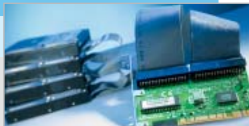
Con un Array Raid si possono accrescere notevolmente le prestazioni dei dischi fissi
