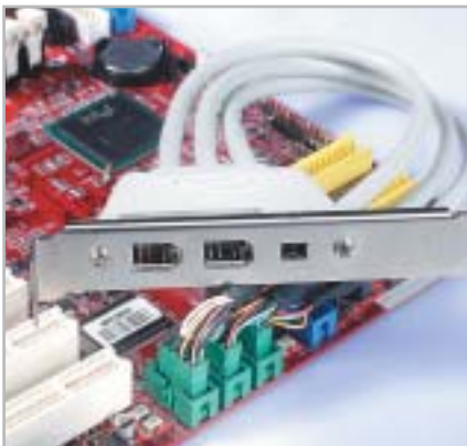
La scheda 845PE di MSI mette a disposizione tre porte firewire, molto utili per i videoamatori
