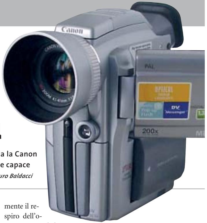
■ Evoluzione del precedente modello MVX1i, la Canon MVX2i impiega un sensore Ccd da 1/4" composto da 1,33 Megapixel, risoluzione che può essere sfruttata nella modalità fotografica per ottenere immagini da 1.280 x 960 pixel, registrabili su schede SD/Mmc (quella fornita a corredo ha una capacità di 8 Mb). Il flash a scomparsa si attiva automaticamente premendo il pulsante di scatto foto, situato nelle immediate vicinanze del comando dello zoom.
