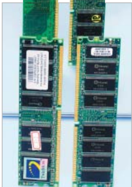
Confronto di memorie: a sinistra un modulo che monta i chip di memoria solo su un lato, e a destra uno sui due lati. La variante di sinistra è più facilmente utilizzabile sulle schede madri Intel
