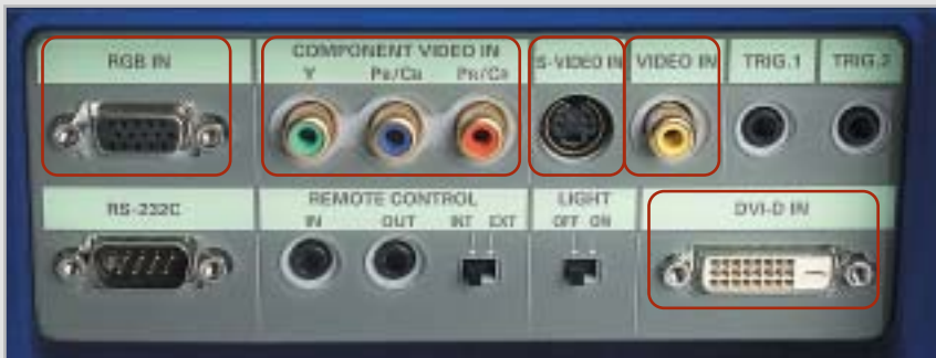
Varietà multicolore: solo i proiettori di fascia alta offrono un numero così cospicuo di connessioni come questo Marantz. Almeno la presa S-Video dovrebbe comunque essere sempre presente
