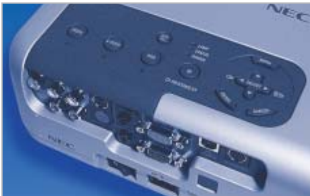
Il pannello di controllo del videoproiettore NEC dispone anche di tasti dedicati per la selezione della sorgente del segnale video
