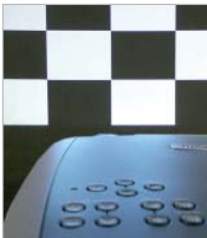
Per meglio valutare il rapporto di contrasto dei videoproiettori si utilizza un'immagine a scacchiera
