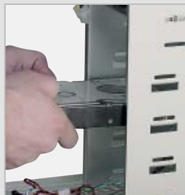
Nel case Cooler Master il montaggio del disco rigido può avvenire in uno qualsiasi degli alloggiamenti inferiori
