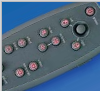
Anche il telecomando a infrarossi del videoproiettore InFocus X1 dispone di tasti retroilluminati
