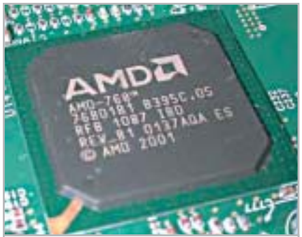
760MPX è il chipset progettato da AMD per le soluzioni a doppio processore di fascia economica
