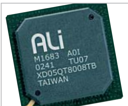
L'ALI 1683 è l'unico chipset di nuova generazione a mantenere la compatibilità con l'Agp a 3,3 volt
