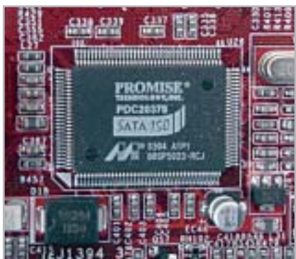
Sulle motherboard 875 e 865 il Serial Ata è di serie: i modelli più completi sono equipaggiati con controller Sata Raid
