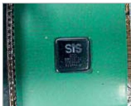
Le funzionalità del chipset SiS 655 sono simili a quelle dell'845 di Intel, orientandolo alle soluzioni multimediali
