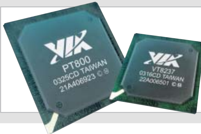
Il PT800 di VIA è la naturale evoluzione del P4X400: supporta i nuovi Pentium 4 con Fsb a 800 MHz
