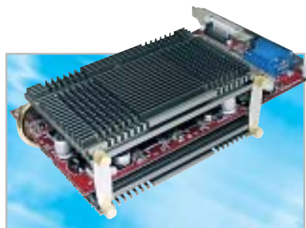
Sistema di raffreddamento della scheda grafica di Zalman: utilizza un condotto heatpipe, che non richiede ventole
