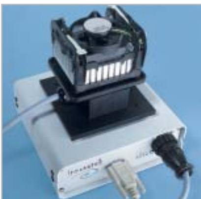
L'emulatore di Cpu KT4 di Innovatek utilizzato per le prove
