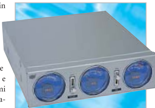
Ritorno al passato: i sistemi di controllo più "trendy" impiegano Vu-meter analogici per visualizzare gli Rpm delle ventole
