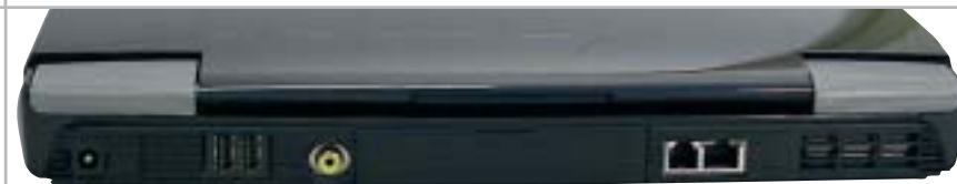
Il Toshiba M10 può essere collegato a un televisore, in virtù dell'uscita composita presente sul retro del notebook; peccato non ci sia un'uscita S/Pdif per l'audio digitale
