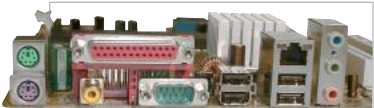
La dotazione della scheda madre Asus A7V600 è delle più complete, manca solo la porta firewire IEEE 1394
