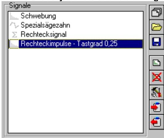
In der Signalliste werden alle zum Projekt gehörigen Signale angeführt. Das aktive Signal kann durch Klicken ausgewählt werden. Es wird dann im Liniendiagramm dargestellt. Außerdem ist an der Farbe der Signalsymbole erkennbar, ob sie sichtbar geschaltet sind. Sichtbar geschaltete Signale werden auch dann gezeichnet, wenn sie nicht aktiv sind, z.B. um sie mit dem aktiven Signal zu vergleichen. Das aktive Signal kann durch einen rechten Mausklick in der Signalliste oder im
